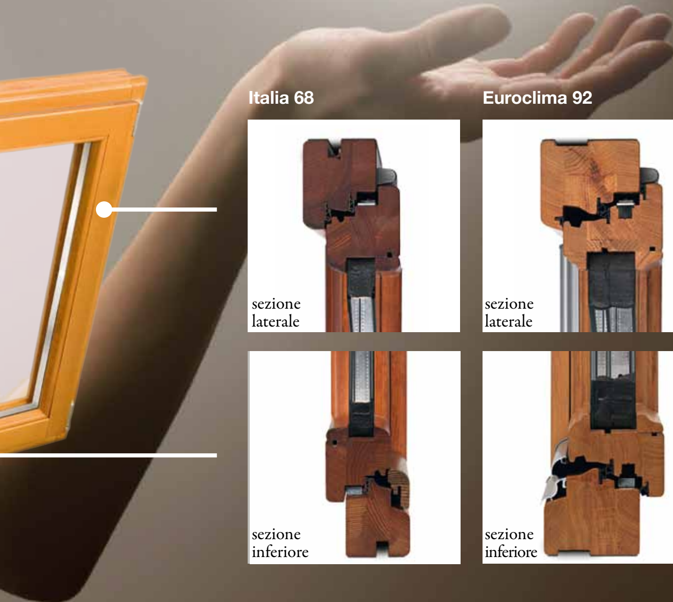
soglia a taglio termico per un migliore isolamento
